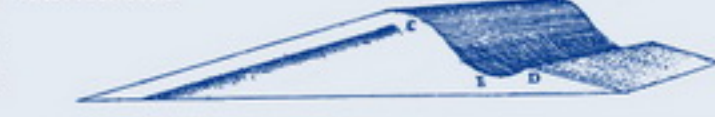
Sección de un azud proveniente de "Los veintún libros de los ingenios y máquinas". Pedro Juan de Lastanosa, pseudónimo Juaneto Turriano (siglo XVII)
